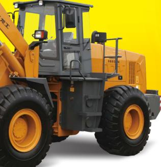
162kW/2200rpm **RATED POWER:** 3.0 m<sup>3</sup> **BUCKET CAPACITY**: 5000kg RATED PAYLOAD: OPERATING WEIGHT: 16800kg/17000kg
